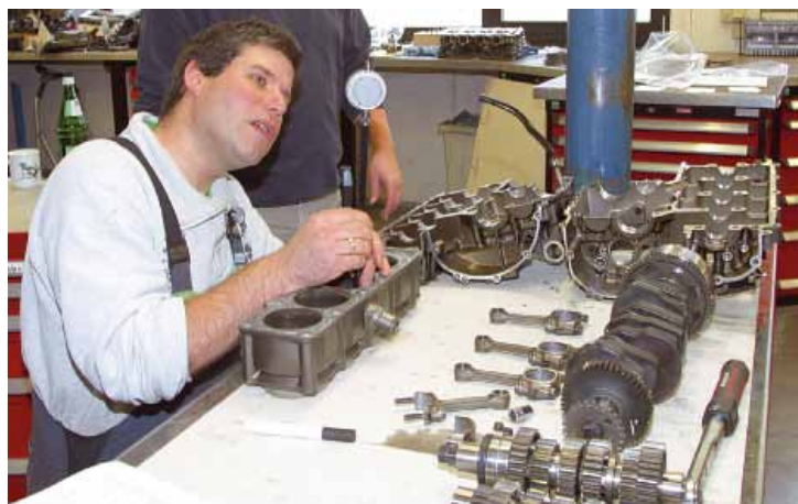
Bestandsaufnahme: Wird der Motor revidiert, werden die Einzelteile genau vermessen. Bei unserer Dauertest-Z 1000 war allerdings alles im Lot
