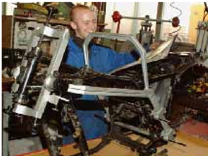
Messen und richten: Hat es beim Sturz den Rahmen erwischt, hilft einer der zahlreichen Richtbetriebe weiter – ein sehr verantwortungsvoller Job
