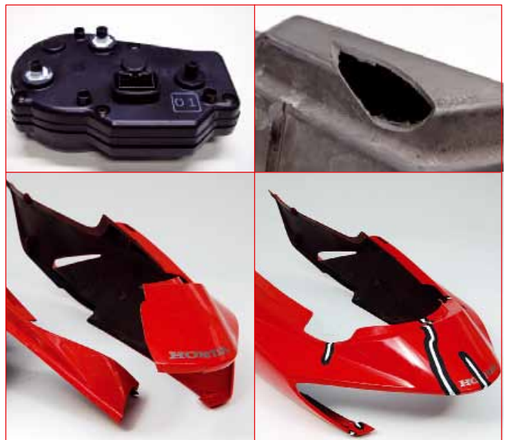
Immer guter Hoffnung: Plastec Kunststoffschweißtechnik repariert Verkleidungen, Tachogehäuse und sogar geknackte Seitenkoffer
