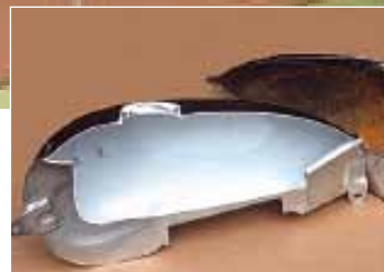
Gammel im Tank? Privatiers drehen und wenden den Tank zum Versiegeln per Hand, Profis nutzen Spezialgerät. Mit der Maschine wird die Beschichtung perfekt
